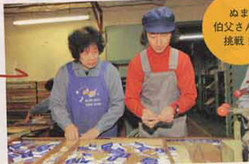
機械で箱に詰められたマッチを検品。「足りなければ補充し、はみ出れば取り除く」
