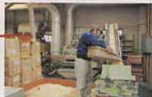
軸は既に加工された状態で中国から輸入。パイプで軸を風圧で機械へ送り込む。
